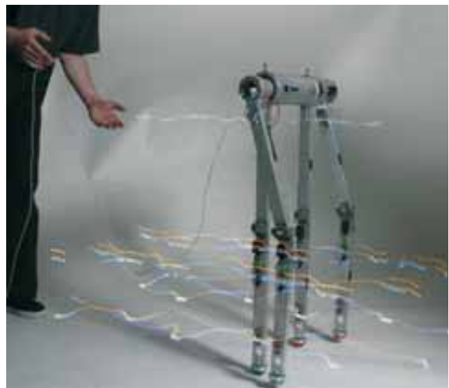
Figuur 9. Dribbel tijdens een loopbeweging. De foto is gemaakt door in een donkere ruimte de sluiters lang open te zetten, waarbij één keer is geflitst. De lichtstrepen geven de positie in tijd en ruimte weer van de status- en indicatie-LED's op alle modules op de robot. De onderbrekingen in de patronen worden veroorzaakt door de knipperfrequentie van de LED's. De blauwe strepen geven de status van encoders weer, de gele het communicatiepatroon (100 Hz) weer.
