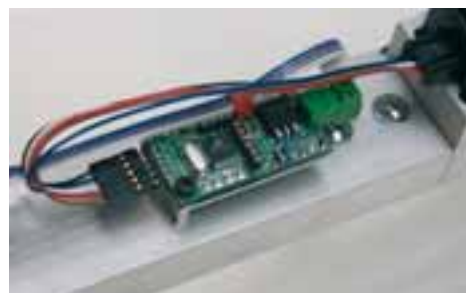
Figuur 6. Print op de knie. Deze print leest de encoder in, bestuurt de knievergrendeling en is verbonden met de TWI-bus door de vier gekleurde draden.
